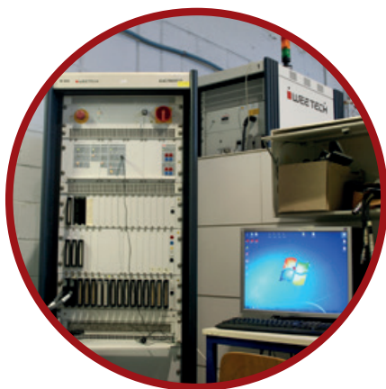
TEST FUNZIONALI DI CABLAGGI Corto Circuito - Continuità - Dielettrico Isolamento alta tensione (fino a 2000V) Emettono rapporto di prova univoco per cablaggio con rintracciabilità del cablaggio e del lotto abbinato
